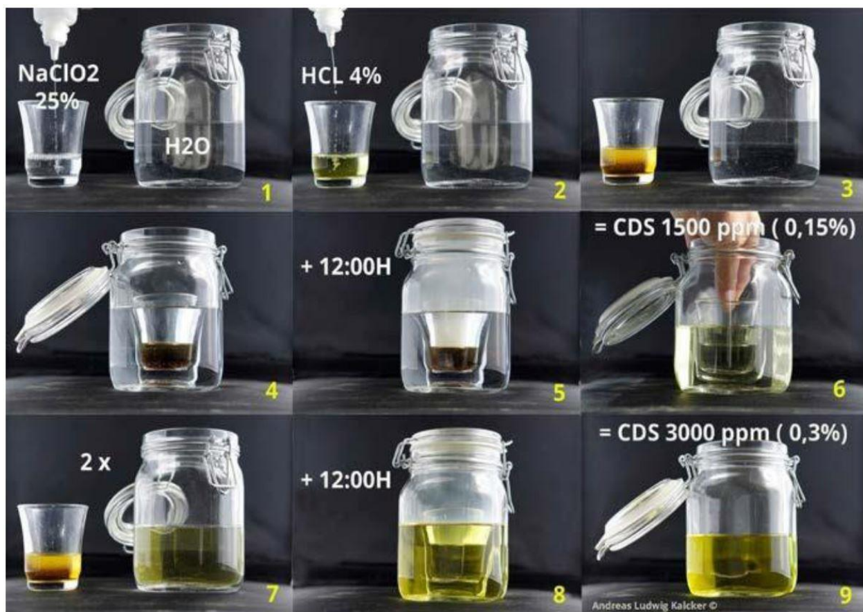
Fig. 50: Preparazione di CDS con acido cloridrico come attivatore.
